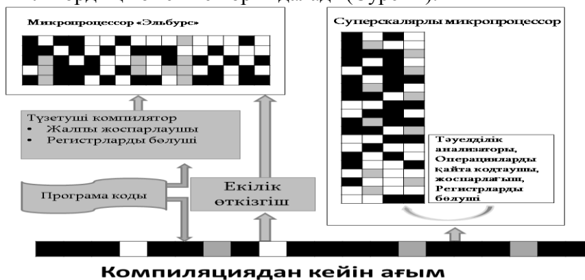
Сурет 1. Микропроцессорлы «Эльбурс» пен суперкалярлы микропроцессорлардың параллельдеудегі айырмашылығы
