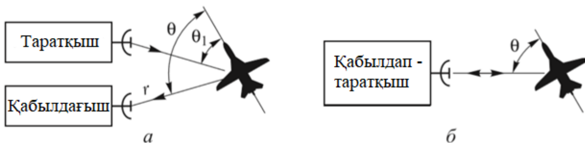
1-сурет – Қайталама сәулеленуді қоздыру және қабылдау: а — қабылдағыш және таратқыш таратылған; б-қабылдағыш және таратқыш біріктірілген
