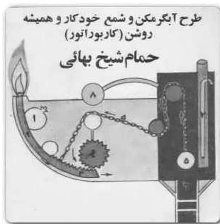
Рисунок 3. Схема механизма обогрева бани
