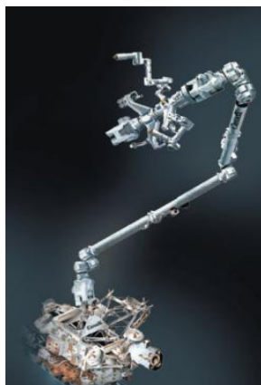
Сурет. 2. ХҒС мобильді сервистік жүйесі (материалдар бойынша NASA). Негізді жылжыту мүмкіндігі қарастырылған станцияға қатысты манипулятор
