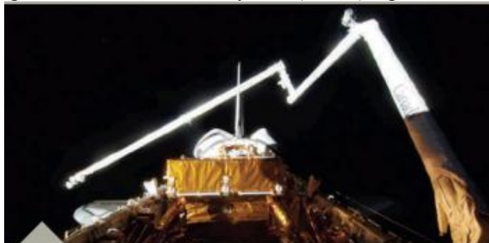
Сурет. 4. Orbiter Beam Sensor System (OBS), STS-125 миссиясында Canadarm-мен бірге қолданылады, мамыр 2009 (NASA суреті)
