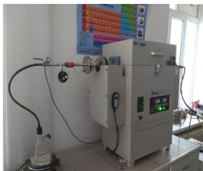
Сурет 2 Карбонизация және активация процесіне арналған BR-12NRT зертханалық айналмалы жоғары температуралы пеші
