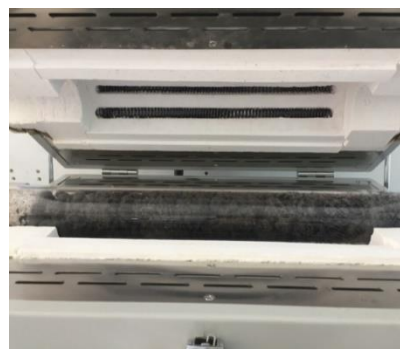
Сурет 2 Карбонизация және активация процесіне арналған BR-12NRT зертханалық айналмалы жоғары температуралы пеші
