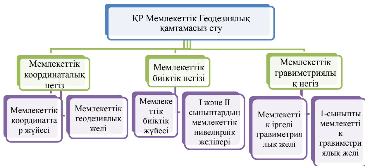
1-схема: Мемлекеттік геодезиялық қамтамасыз ету жүйесі
