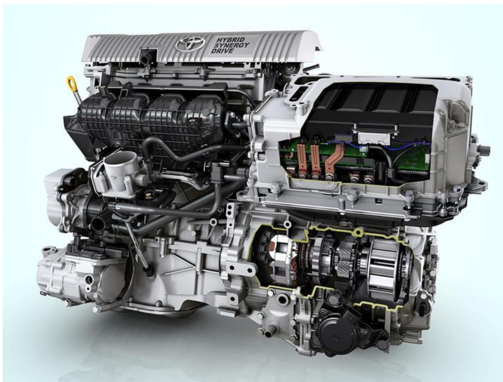
2 сурет – ІЖҚ-на оң жақта екі электр қозғалтқышы бар трансмиссиялық модуль түйіскен. Оң жақта шеткі — тартымдық электрқозғалтқыш, сол жақта планетарлық беріліс редукторы орналасқан, ал электрқозғалтқыштар мен ІЖҚ-ы арасында — мотор-генератор орналасқан, ал бұл – стартер қызметін де атқара алады.
