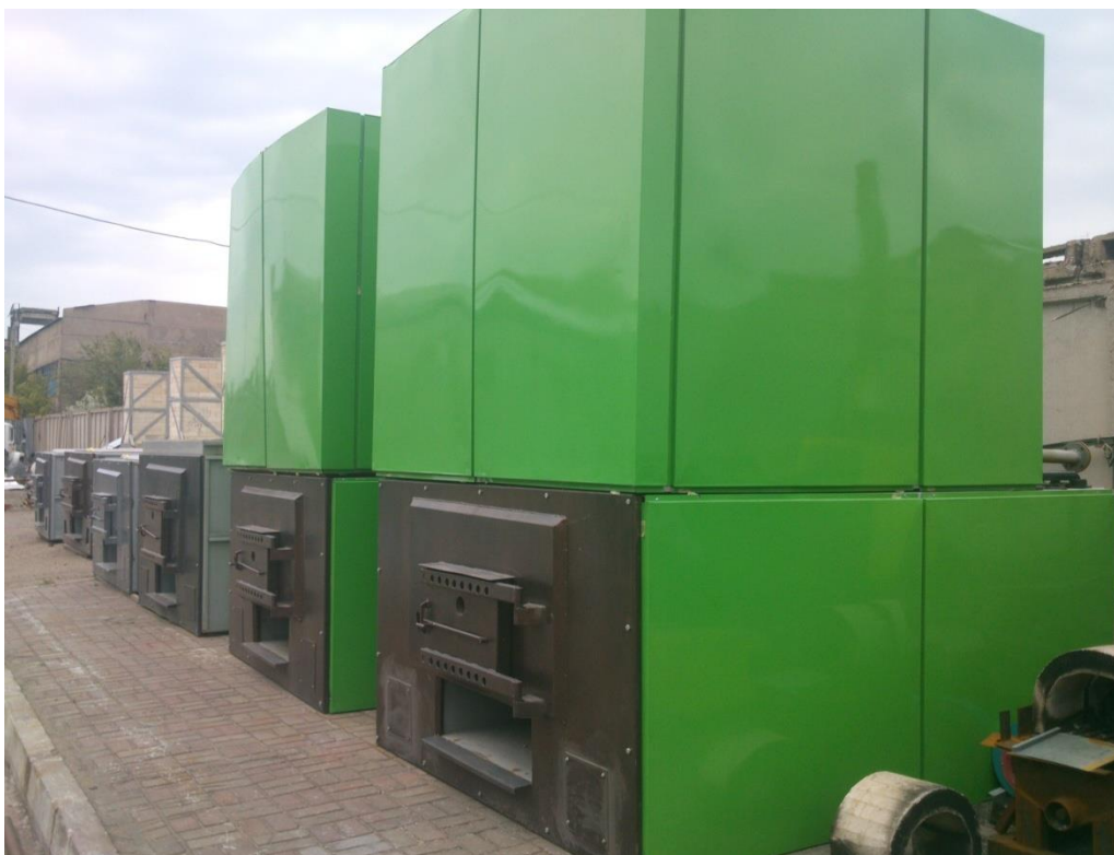
Рисунок 1 –Модернизированный котел с вихревой топкой
