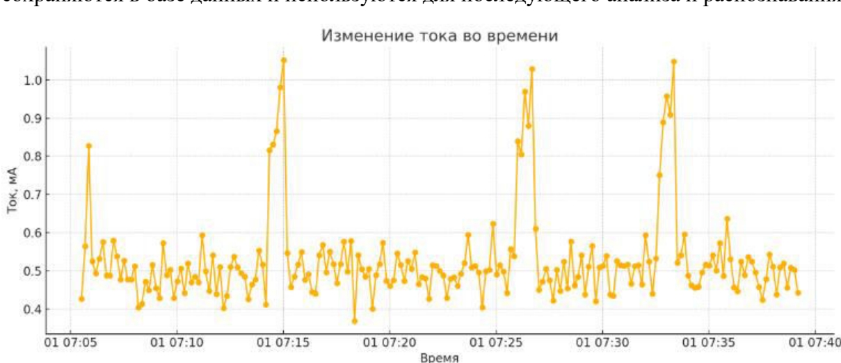
Рис 1. Оцифрованные показания замеров работы тестового устройства на включение и выключение. Основа для формирования цифровой сигнатуры.
