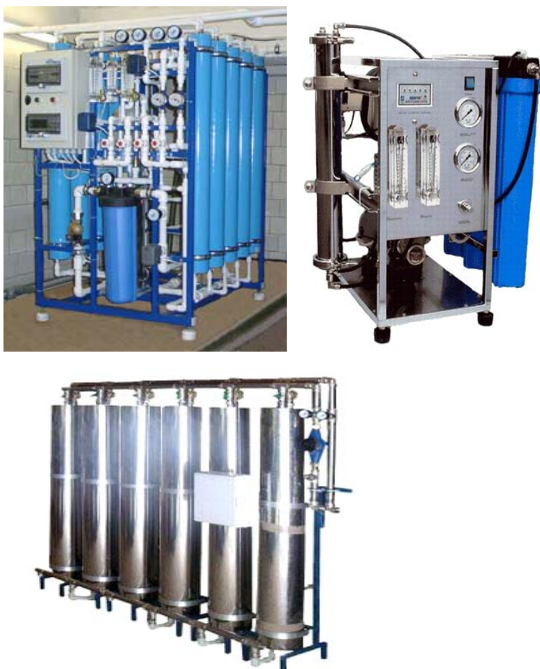
Рисунок 1 - Мембранные системы водоподготовки
