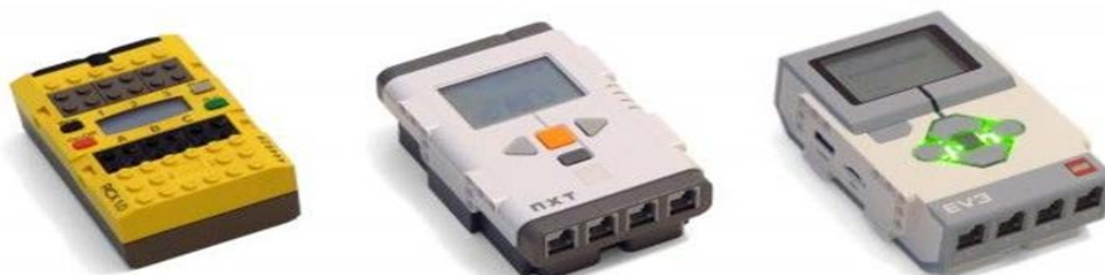
Сурет 1 – Солдан оңға қарай Lego микрокомпьютерлері: RCX (1998 ж.), NXT (2006ж.), EV3 (2013 ж.)
