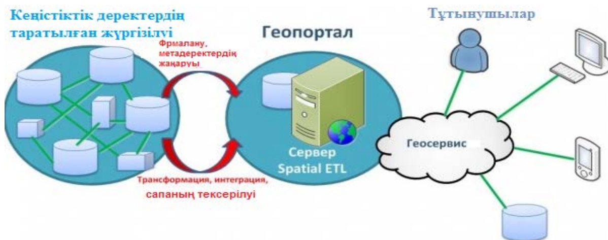
Сурет 2 - Spatial ETL-ді геопортал архитектурасында пайдалану.
