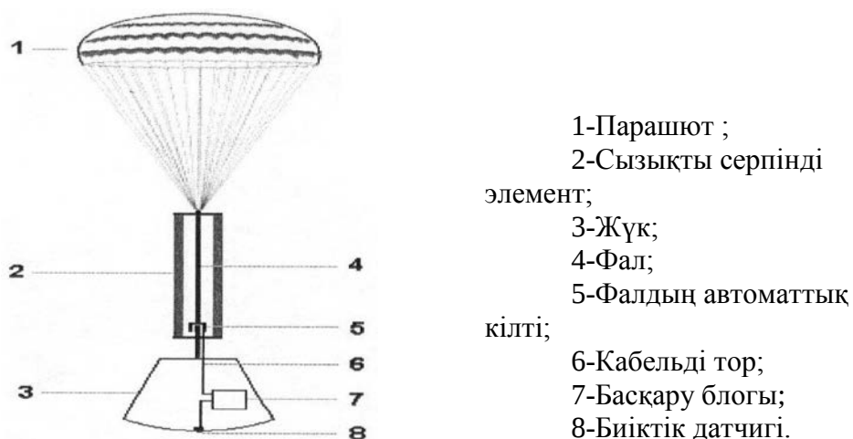
3-сурет. Негізгі функционалдық элементтері бар қондырғының сұлбасы
