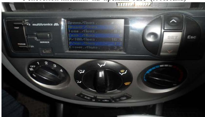
Рисунок 2 - Бортовой компьютер определения параметров автомобиля Chevrolet Lacetti 1.6 MT (г. Астана)
