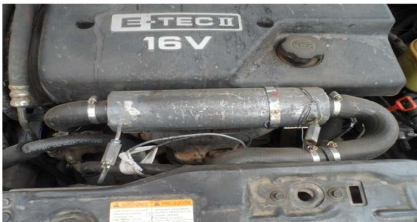
Рисунок 1 - Двигатель автомобиля Chevrolet Lacetti 1.6 MT с системой питания на крекинг-газе (г. Астана)
