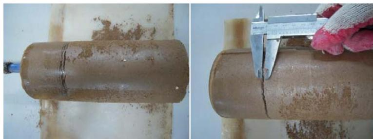
Рис. 3. Прослойки льда в образцах грунтов
