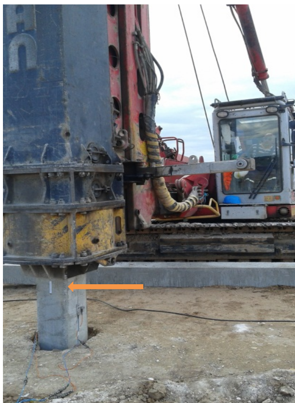
Рисунок 1. Испытания свай динамической нагрузкой
