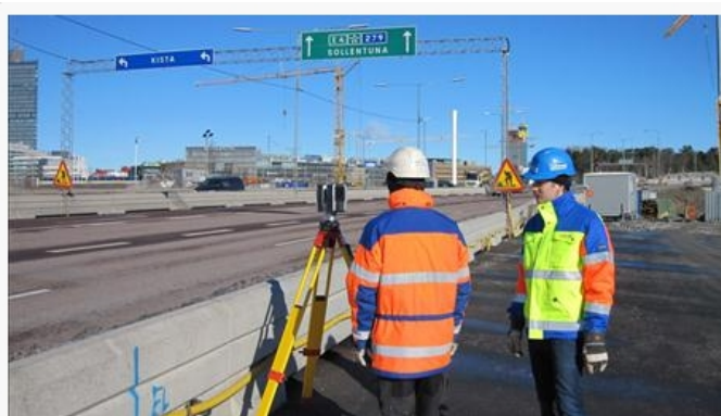
Рис.1 - 3D сканирование дорожных участков с помощью наземного лазерного сканера
