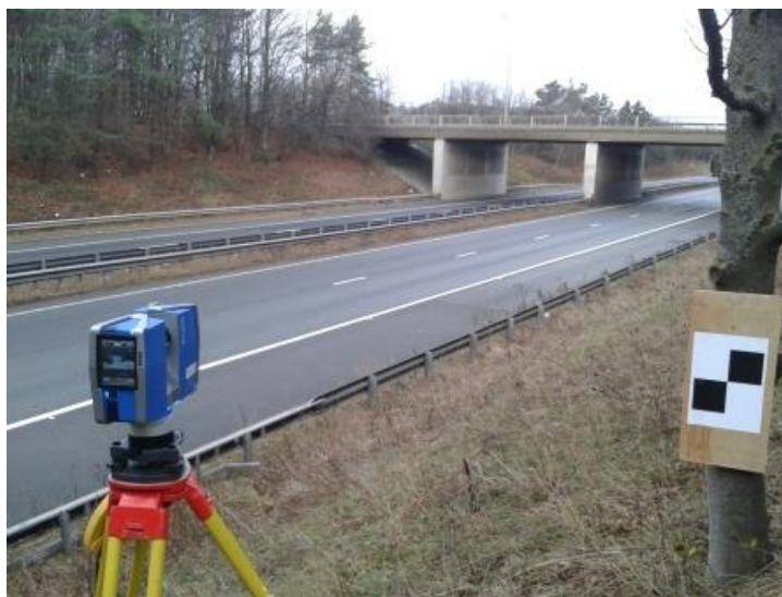
Рис. 2 – Выполнение сканирования с помощью Faro Focus 3D
