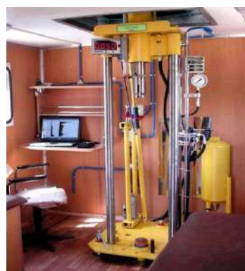
Рисунок 2. Установка статического зондирования УСЗ 15/36А (вид снаружи и внутри).
