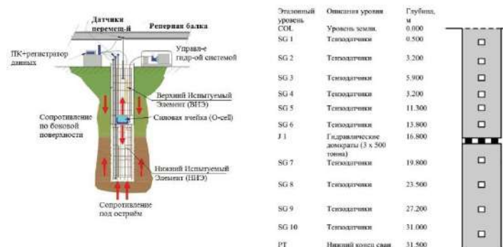
Рисунок 3. Схема тестирования свай методом O-cell
