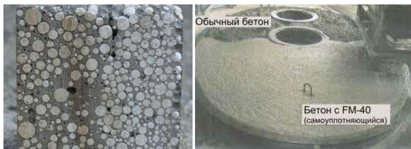
Рис. 3 Самоуплотняющийся бетон в разрезе Рис. 4 Обычный и самоуплотняющийся бетон
