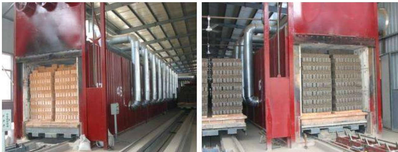
Рис 7. Современная туннельная печь для обжига керамического кирпича и камня
