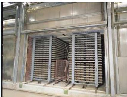
Рис 5. Сушилка камерного типа
