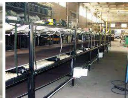
Рис 6. Сушилка конвейерного типа
