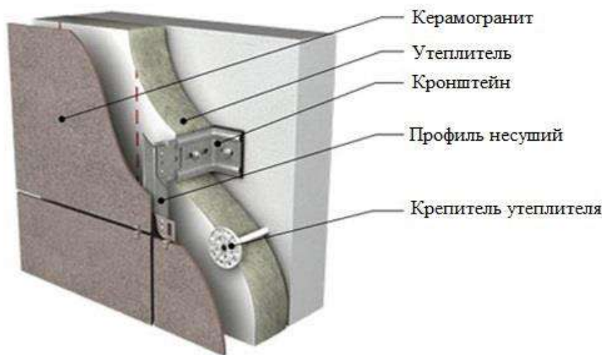
Рис. 5. Состав стены из вентилируемого фасада с облицовкой керамогранитом.
