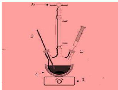
1- магниттік айналырғыш, 2- прекурсорларды ендіру, 3- термоконтрольге қосылған терможұптар, 4- қолба қыздырғыш
