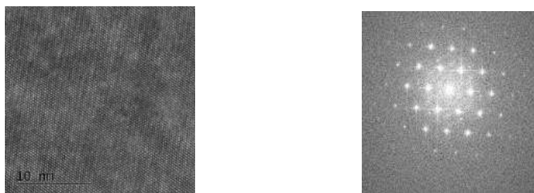
Рисунок 3 - ПЭМ снимок структуры монокристалла \text{MgAl}_2\text{O}_4
