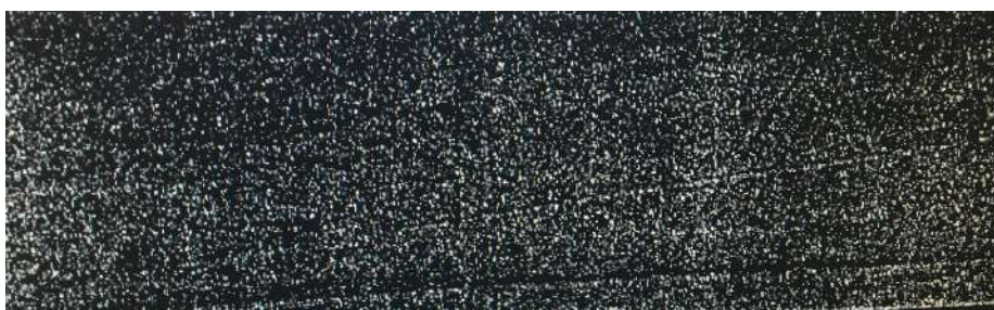
Рисунок 4. Сталь 1. 2379. Твердость:58HRC, шлифованная, полировка алмазной пастой 6мкм войлочным притиром, R_z=0.30 мкм, R_a=0.04 мкм
