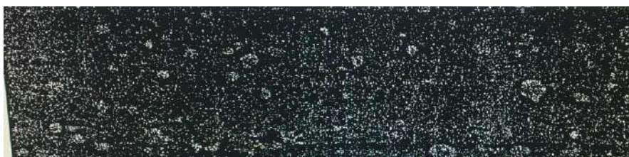
Рисунок 2. Сталь 1. 3343. Твердость:63HRC, шлифованная, полировка алмазной пастой 6мкм войлочным притиром, R_z=0.25 мкм, R_a=0.03 мкм
