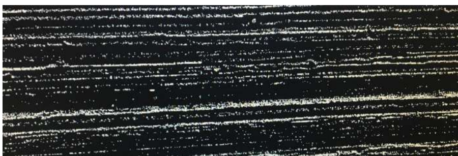
Рисунок 3. Сталь 1. 2379. Твердость:58HRC, шлифованная, R_z=3.19 мкм, R_a=0.34 мкм
