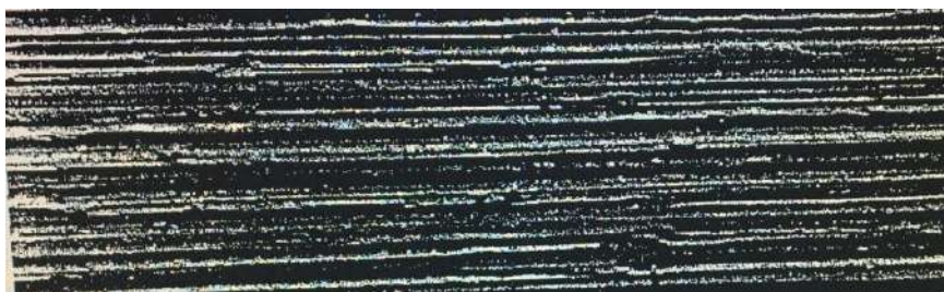
Рисунок 1. Сталь 1. 3343. Твердость:63HRC, шлифованная, R_z=2.72 мкм, R_a=0.32 мкм
