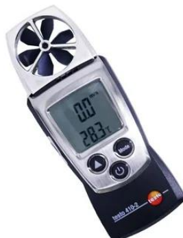
Рисунок 3 – Многофункциональный анемометр Testo 410–2 для измерения скорости подачи поддува или ветра
