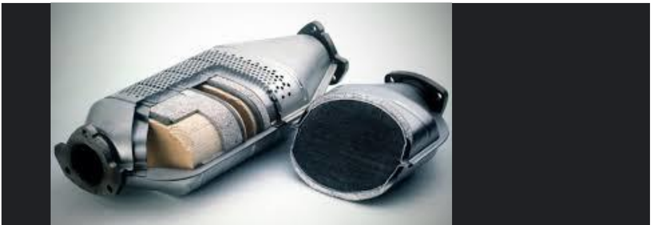
Рисунок 3. Катализатор и его устройство
