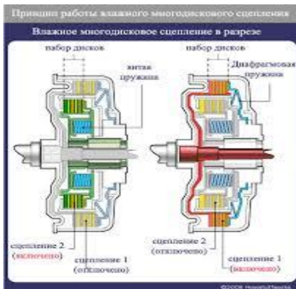
Рисунок 2. Принцип работы сцепления
