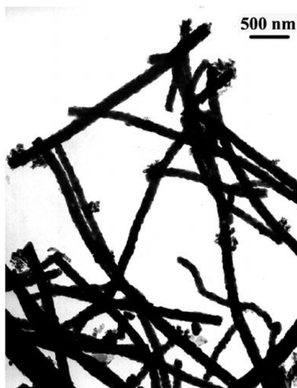
Рисунок 3 – Нанопроволоки \text{Cu}_2\text{S} 8 по работе [5]
