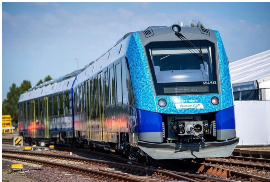
Сурет-1. Coradia iLint бұл сутегі отын элементтерімен жұмыс істейтін әлемдегі Алғашқы пойыз
