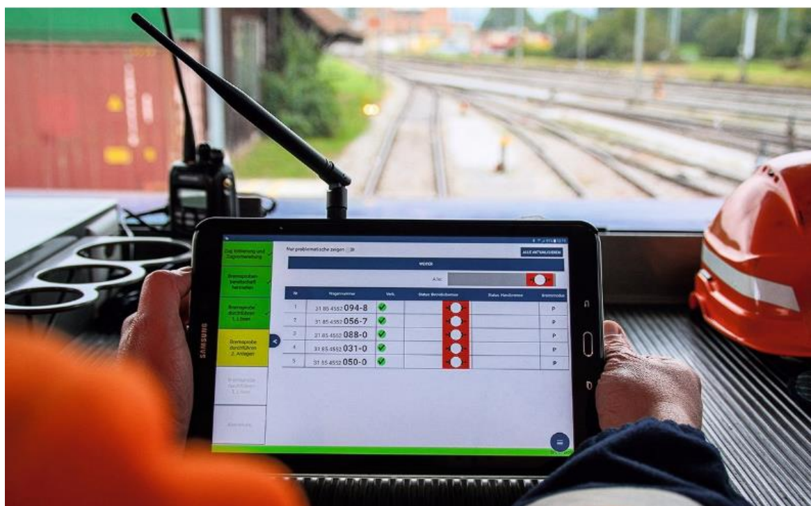
Рисунок 2 - Результат автоматического опробования тормозов на планшетном компьютере в кабине машиниста во время испытаний технологии
