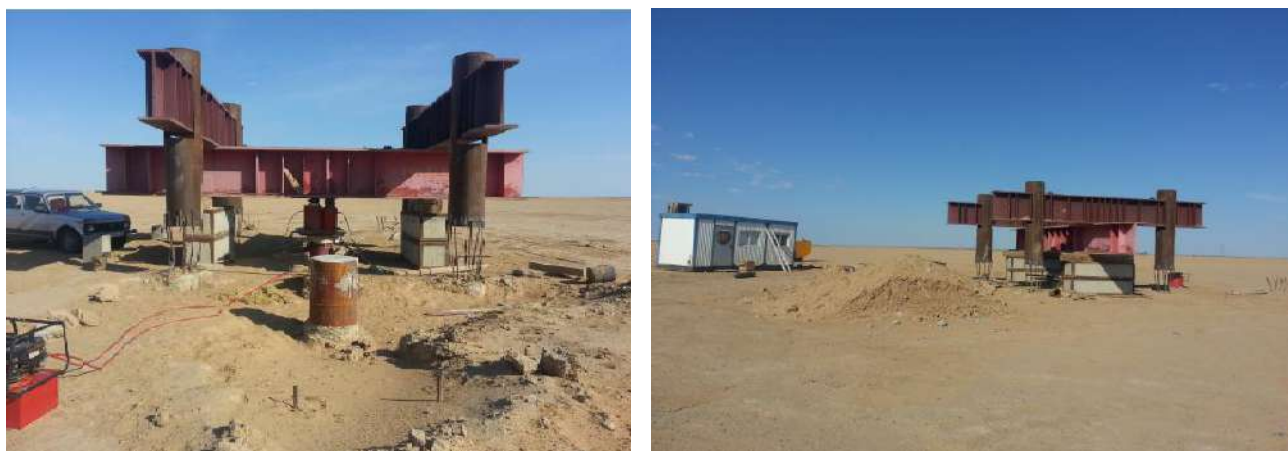
Рисунок 1. Процесс испытания буронабивных свай
