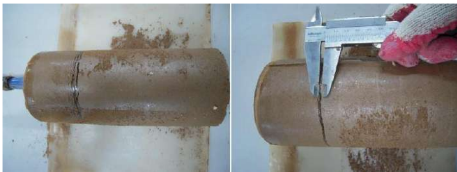
Рис. 3. Прослойки льда в образцах грунтов
