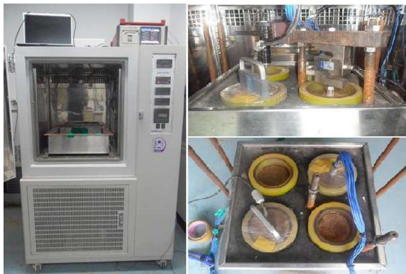
Рис. 2. Лабораторные оборудования и установленные образцы грунтов, готовые к лабораторным испытаниям
