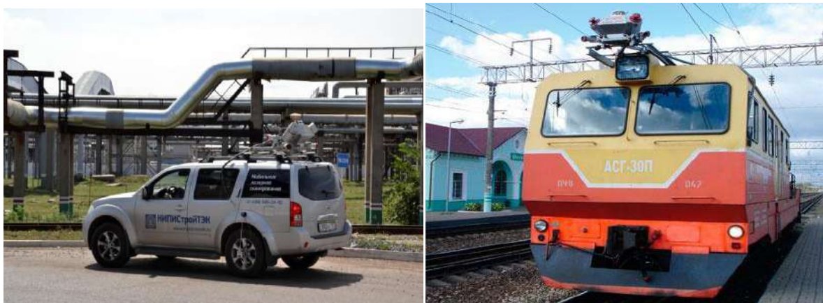
Рис. 5 Варианты установки системы мобильного сканирования Riegl VMX-250
