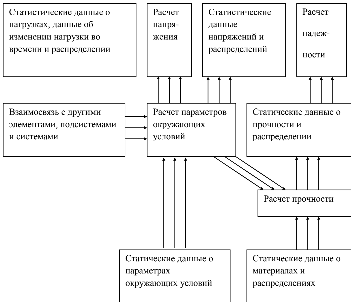
Рисунок - Блок-схема, показывающая применение вероятностных методов при проектировании.
