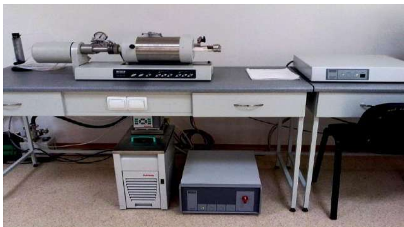
Рисунок 1. Внешний вид дилатометра DIL-402CD (МНИК)
