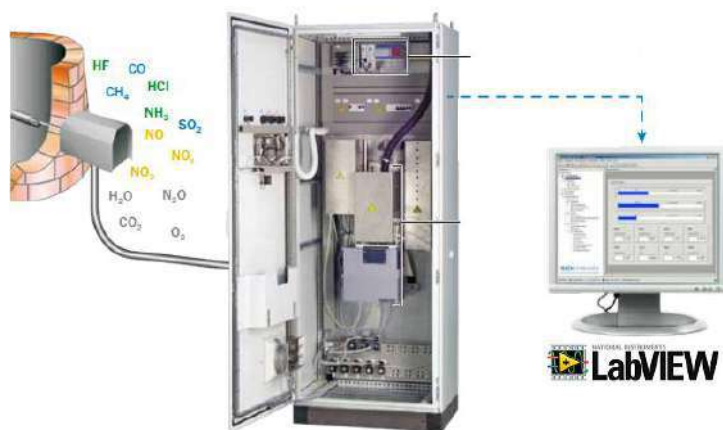
Сурет 3. MCS100FT газоанализаторлық кешенінің құрылымы
