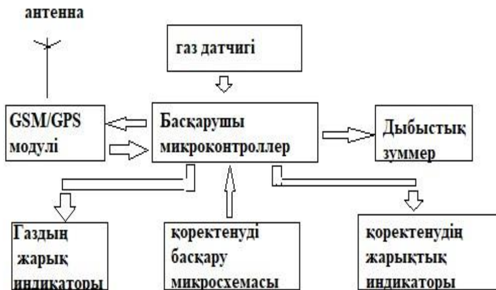
Сурет 1 – Құрылғының құрылымдық сұлбасы
