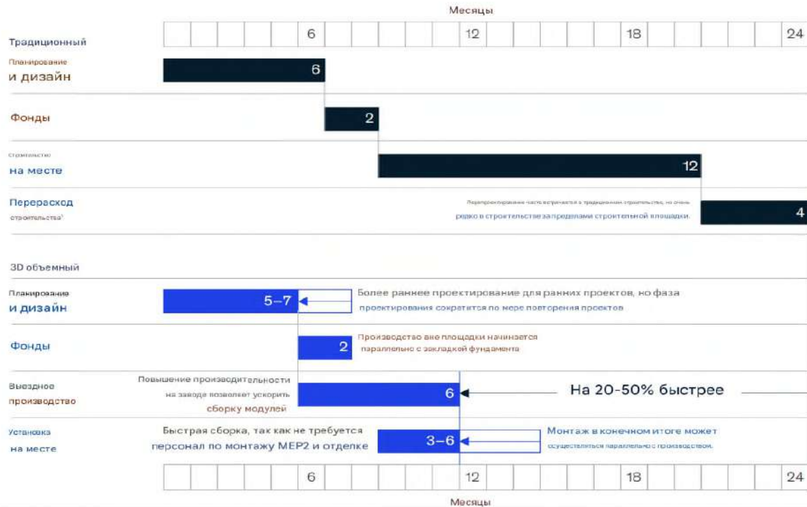
Рисунок.3 – Сжатие графика строительства при использовании 3D – объемных модулей
