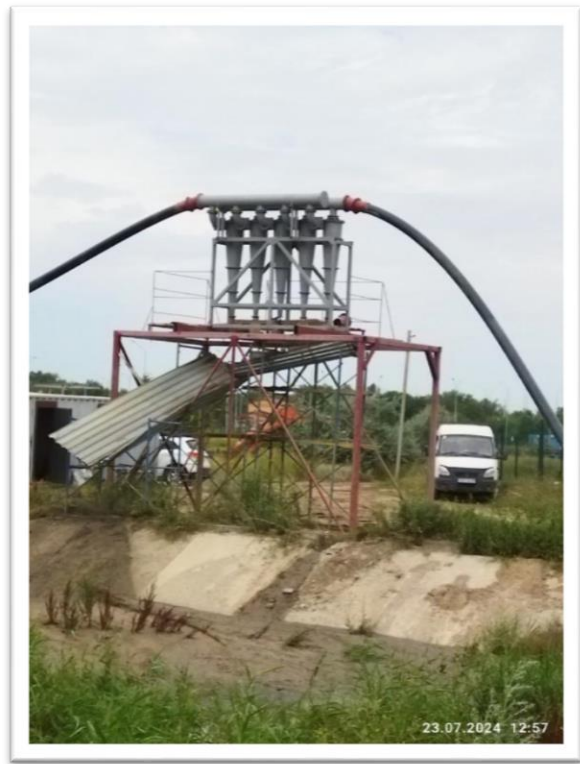
1-сурет. Өзен арнасын тазалауда гидроциклондарды қолдану
