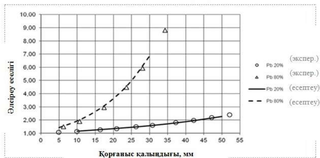
Сурет 4. Гамма-сәулелену дозасы қуатының әлсіреу еселігінің ( ^{198}\text{Au} көздері) Pb толтырғышы бар "Абрис Рзңқ-02" маркалы қорғаныс материалының қалыңдығына есептік және эксперименттік тәуелділігі
