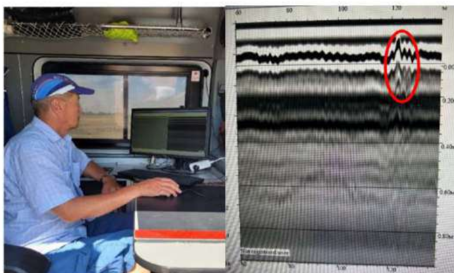
Рисунок 1.5 - Радарограмма с аномалией дефекта дорожной одежды
