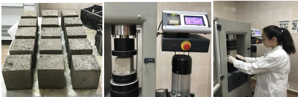
4.1-сурет - Бетонның сығылу беріктігі сынағы
