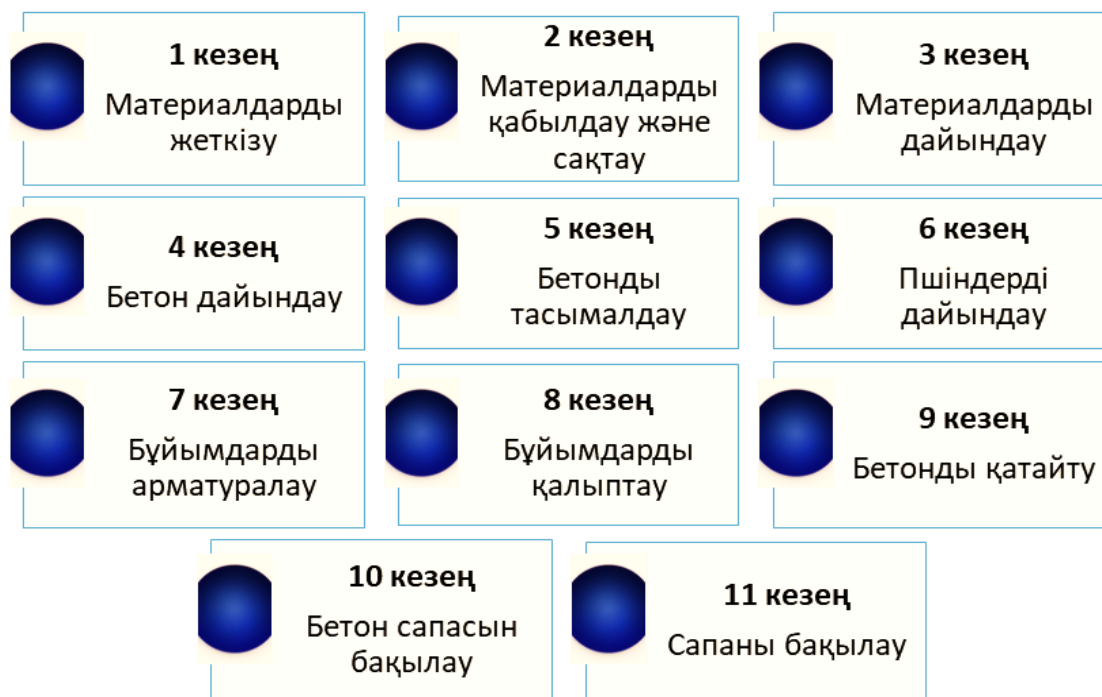
1.2-сурет - Бетон қоспасын өндірудің технологиялық процесі
