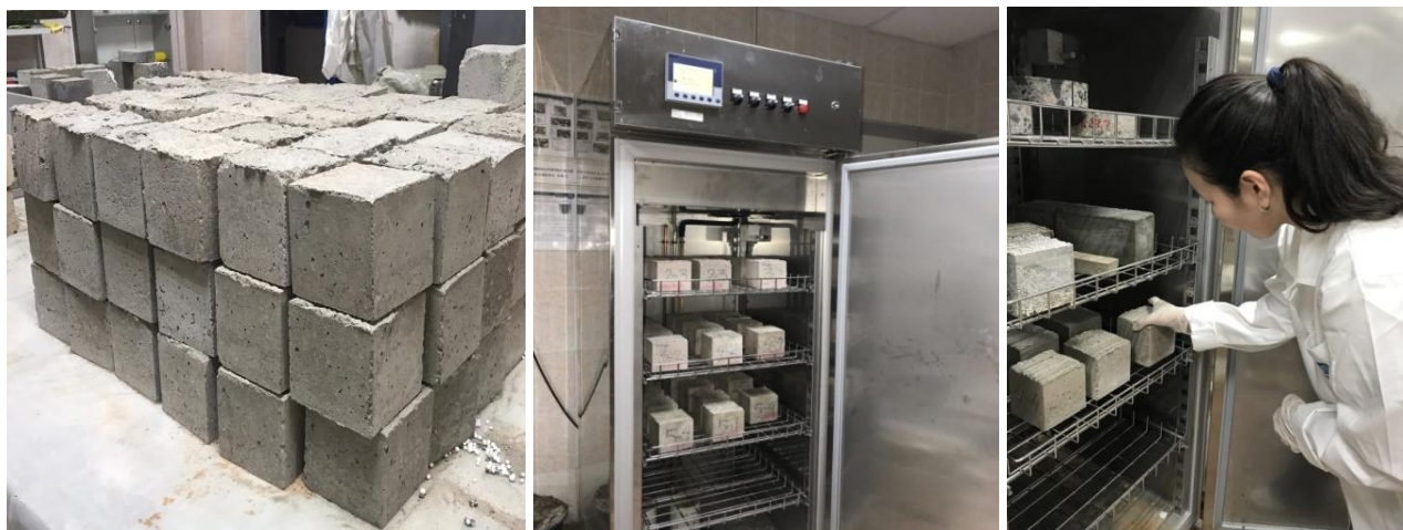
4.3-сурет - Бетонның аязға төзімділігін тексеру
