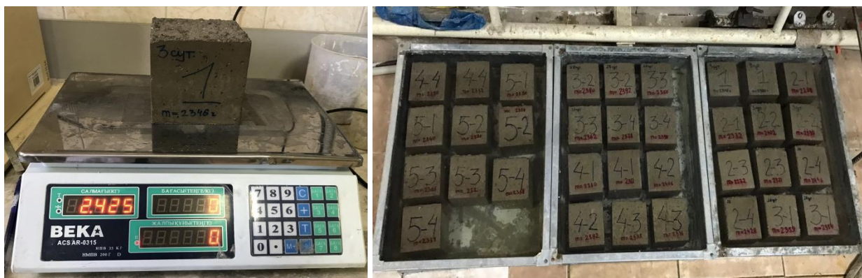
4.2-сурет - Бетонның су сіңіру сынағы
