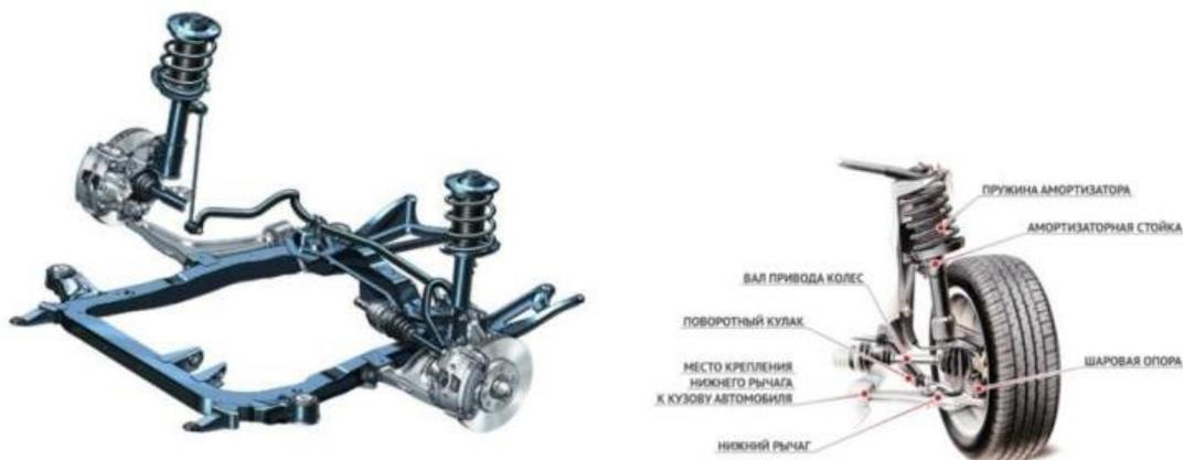
Рисунок 1 – Подвеска автомобиля
