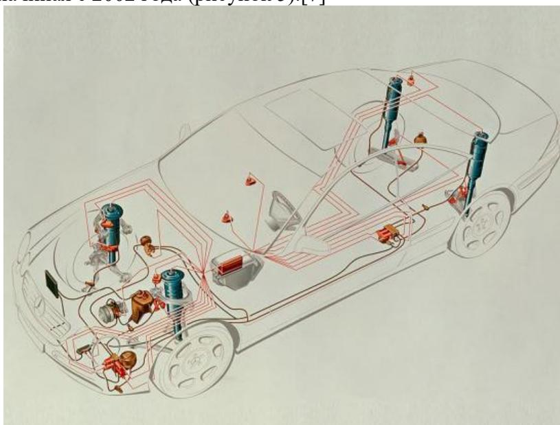
Рисунок 5 – Mercedes Benz CL 500 с активными подвесками «Active Body Control» (ABC)
