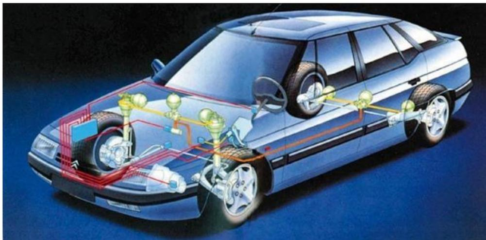
Рисунок 2 – Автомобиль Citroen XM с регулируемой по упругости пневматическими амортизаторами подвески «Hydroactive»
