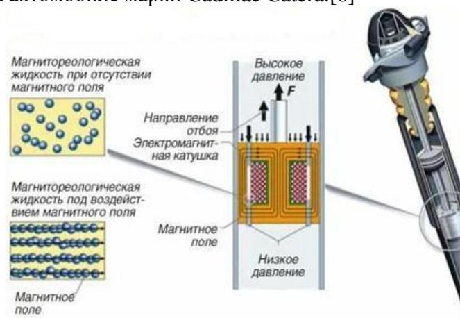
Рисунок 4 – Амортизатор с переменной вязкостью (магнито-реологической жидкостью)
