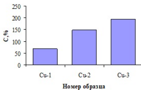
Рисунок 7 – Диаграммы изменения коэффициента поглощения для защитных экранов
