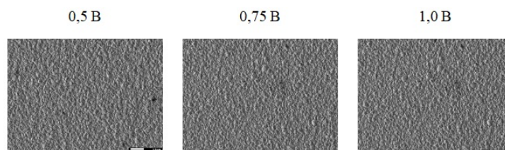
Рисунок 3 – РЭМ изображения поверхности защитных экранов на основе меди
