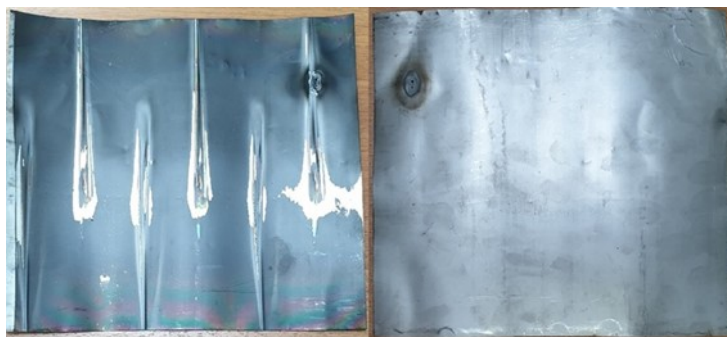
Рисунок 1 – Защитный экран внутренней поверхности плазменной камеры со следами соприкосновения с плазмой и локального нагрева
