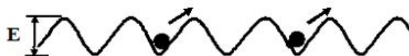
Рисунок 5 – Схематическое изображение потенциальных барьеров вдоль одномерного канала проводимости \gamma - \text{Na}_3\text{Cr}_2(\text{PO}_4)_3 . E - высота потенциальной ямы в канале проводимости, а кружками показано статистическое распределение катионов
