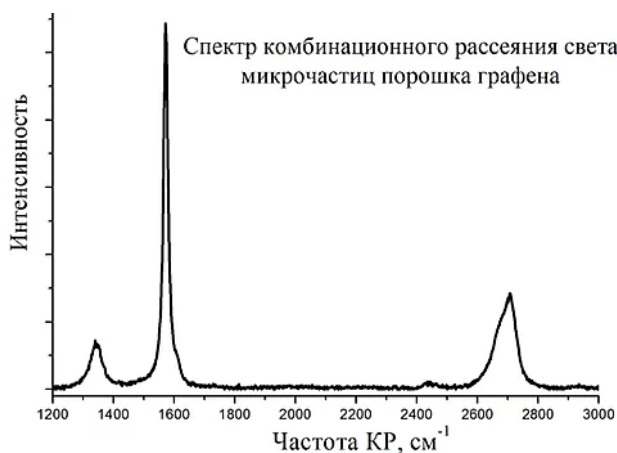
Рисунок 3 – Спектр комбинационного рассеяния микрочастиц порошка графена
