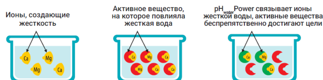
Рисунок 1 – Процесс деактивации ионов Ca и Mg с помощью ПАВ
