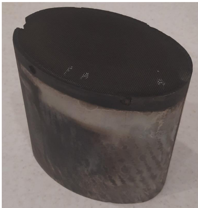
Рисунок 5 – Утилизированный автокатализатор Toyota Mark II, проработавший на бензиновом топливе 28 лет
